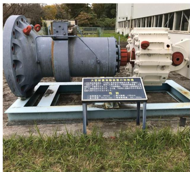
耐震實驗裝置的的加振機 (防災科學技術研究所)
