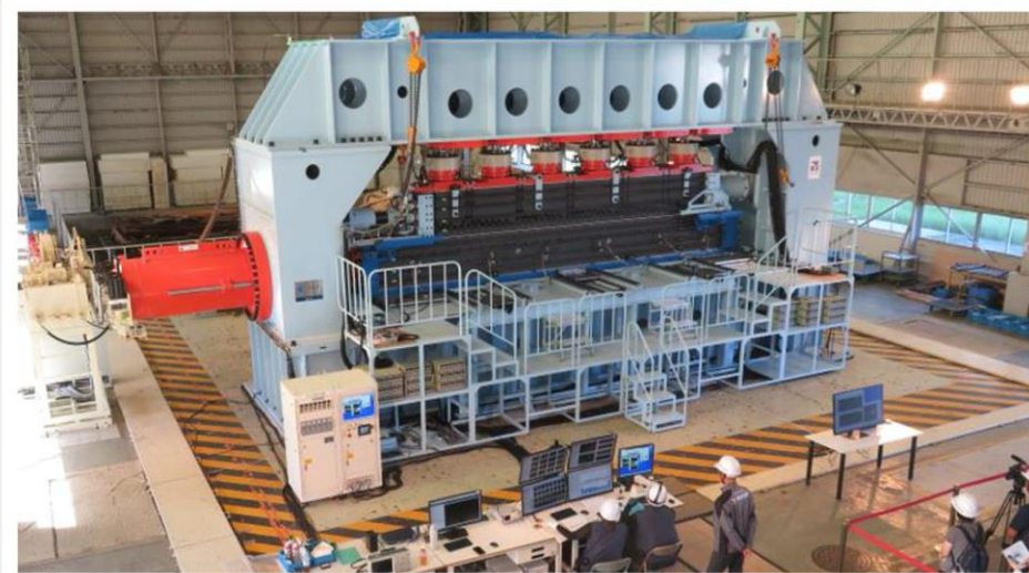
斷層滑動再現裝置 (防災科學技術研究所)
