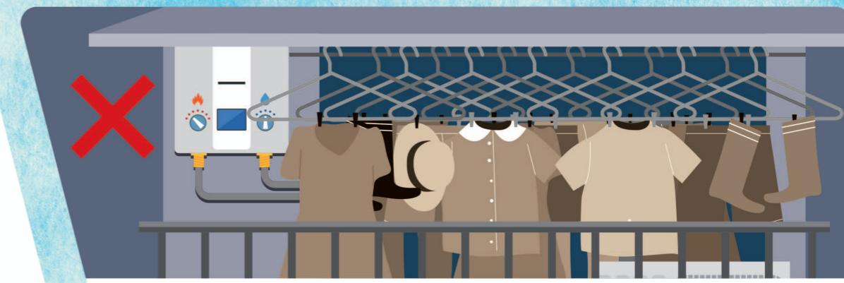
屋外式熱水器(RF式)安裝處所有晾掛衣物或加裝遮雨板等阻礙通風之情形。
