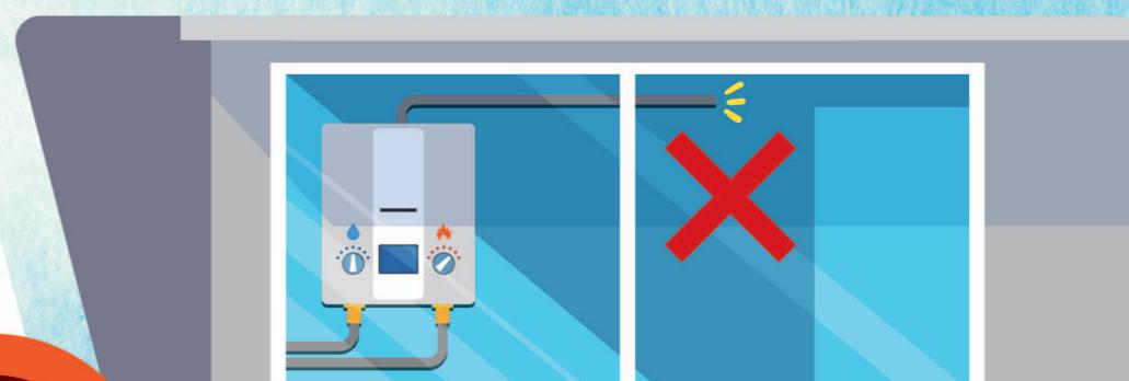
半密閉強制排氣式熱水器(FE式)或密閉強制供排氣式熱水器(FF式)排氣管未延伸至戶外。
