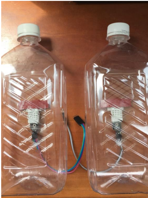
圖五、DHT-22 在寶特瓶內部
