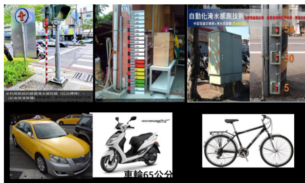
▲ 圖 4-2 估測淹水程度的方式
