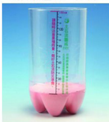
3.將底部不規則部分(約6公分以下)充填石膏固定，以增加重量避免傾倒。
