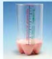
3 將底部不規則部份(約6公分以下)充填石膏固定，以增加重量避免傾倒。
