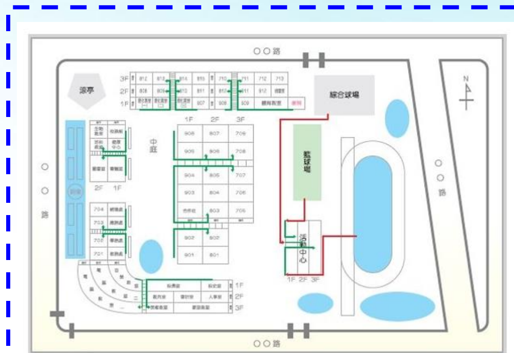
圖例：● 低窪區域(易淹水區)；→ 室內垂直避難路線；→ 室外避難路線
